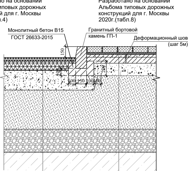
Асфальтовое покрытие (тип 1) Разработано на основании Альбома типовых дорожных конструкций для г. Москвы 2020г. (табл.4)
