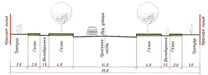
Поперечный профиль улицы: ул. Лётчика Каберова (см. п. 3 примечания)
