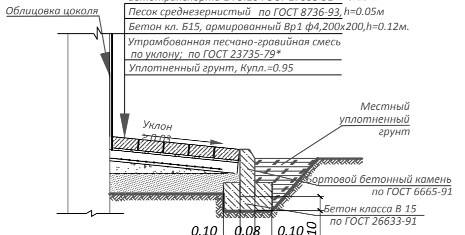
Отмостка с мощением плиткой (тип 7)
