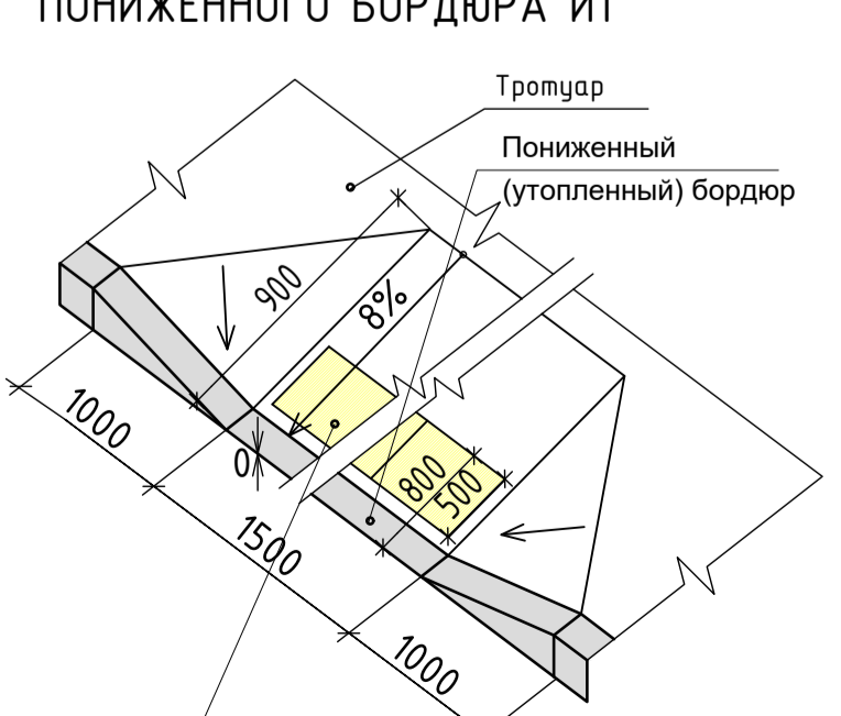
ДЕТАЛЬ УСТРОЙСТВА Пониженного бордюра И1
