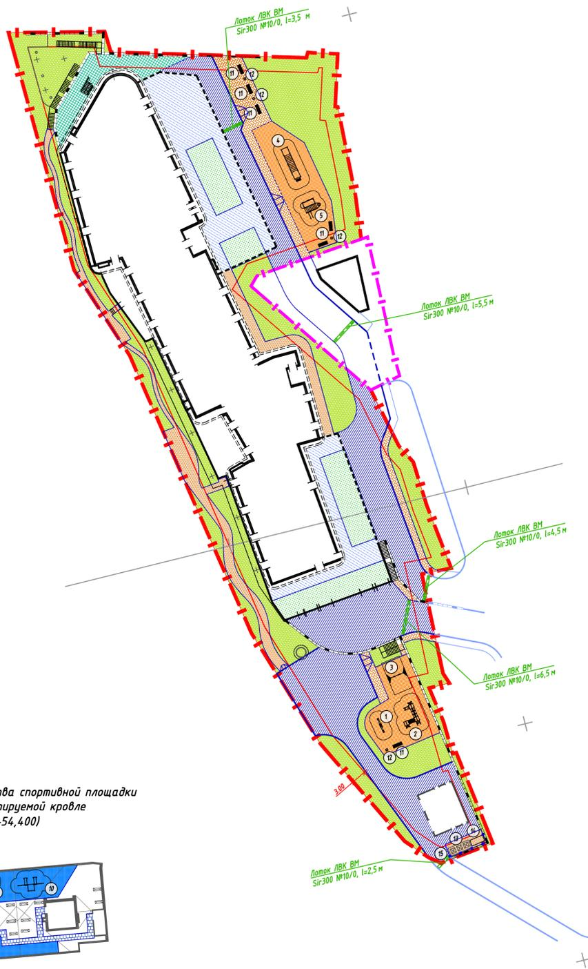
План благоустройства спортивной площадки на эксплуатируемой кровле (отм. +54,400)
