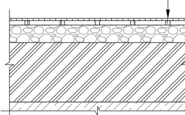
**Газонная полиэтиленовая решетка возможность проезда пожарных машин по стилобату Тип 22**
