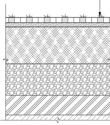
**Газонная бетонная решетка возможность проезда пожарных машин по стилобату Тип 21**
