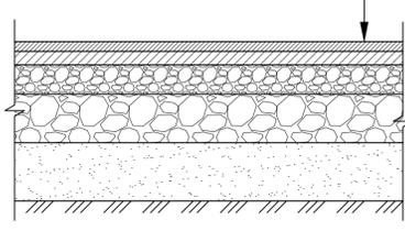
**Покрывие для велосипедных дорожек с возможностью проезда пожарных машин по стилобату Тип 8**
