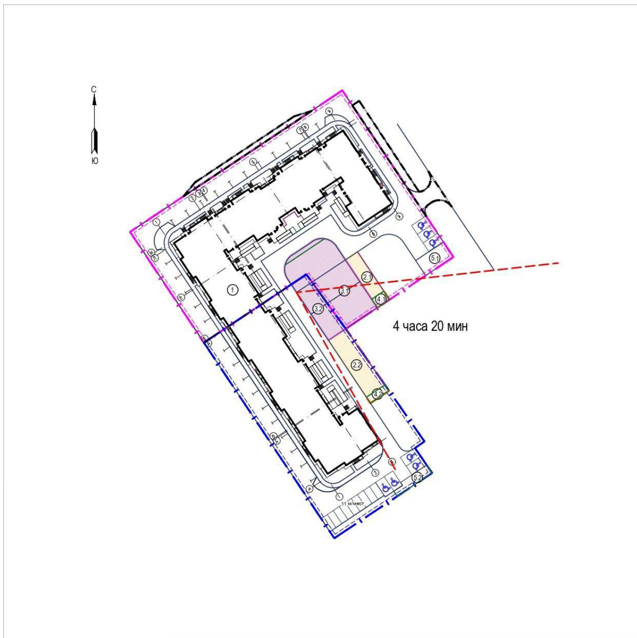
Рис 3 Расчёт продолжительности инсоляции спортивной площадки (поз. 3.2);
