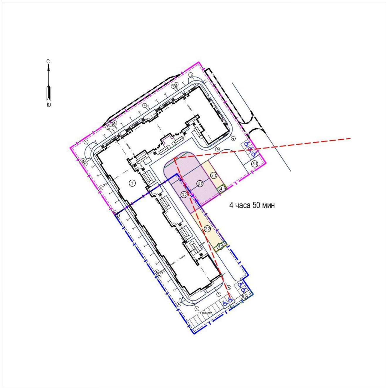
Рис 2 Расчёт продолжительности инсоляции детской площадки (поз. 2.1), спортивной площадки (поз. 3.1) и площадки для отдыха взрослого населения (поз. 4.1);
