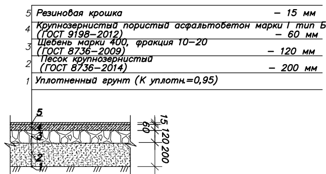
Резиновое покрытие площадок Тун IV
