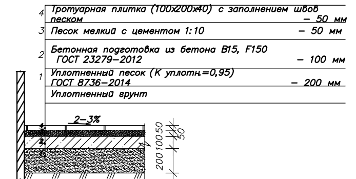
Плиточное покрытие откоски Тун III
