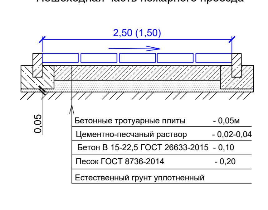
Укрепленный тротуар (тип 2) Пешеходная часть пожарного проезда
