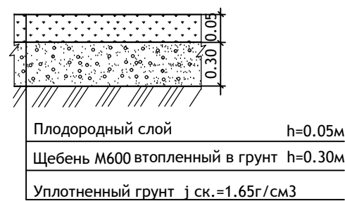
Конструкция полосы для проезда пожарных а/машин Тип 5
