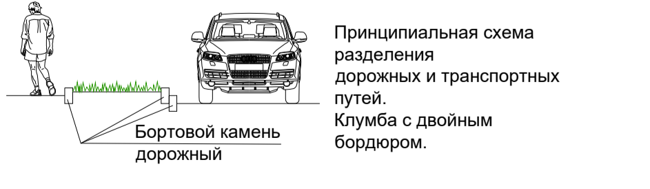
Принципиальная схема разделения дорожных и транспортных путей. Бетонный камень дорожный
