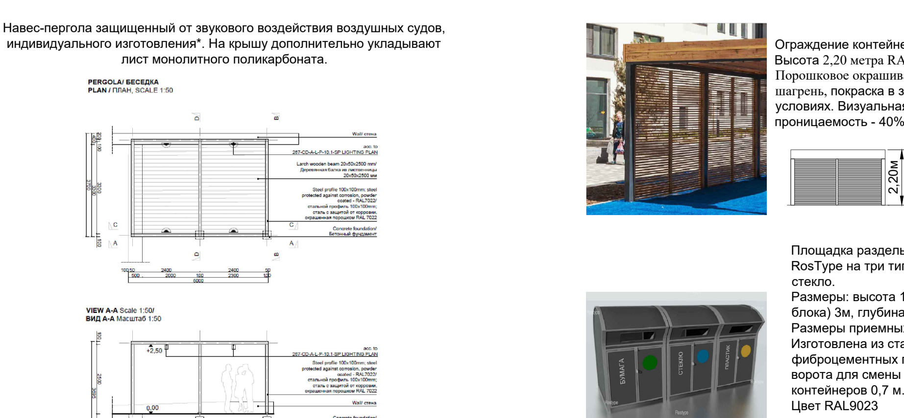
Навес-пергола защитный от звукового воздействия воздушных судов, индивидуальной изготовления. На крышу дополнительно устанавливается лист монолитного поликарбоната. Ограждение контейнерной площадки. Высота 2,20 метра RAL7016. Металл. Порошковое окрашивание, текстура шпатель, поперечная закрывающаяся, звукоизоляция. Визуальная прозрачность - 40% Площадка раздельного сбора мусора ПРС 6 RostType на три типа отходов: бумага, пластик и стекло. Размеры: высота 1,75м, ширина (3 рядом стоек) блок 3м, глубина 0,8м. Размеры прямых осей 400x500/700мм. Изготовлена из стального каркаса и фиброцементных панелей. Имеет двусторонние ворота для смены контейнеров. Емкость контейнеров 0,7 м куб. Цвет RAL9023
