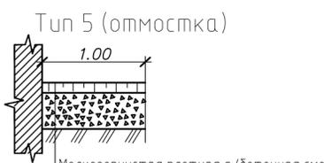
Мелкозернистая плотная а/бетонная смесь тип А марка I по ГОСТ 9128-09 - 0.03 м
