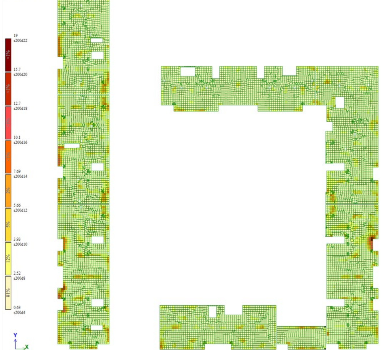
Рис. 7.4.4 Площадь полной арматуры на 1мм по оси Y у верхней грани
