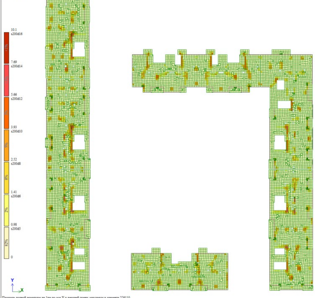
Рис. 7.7.3 Площадь полной арматуры на 1м по оси X у верхней грани
