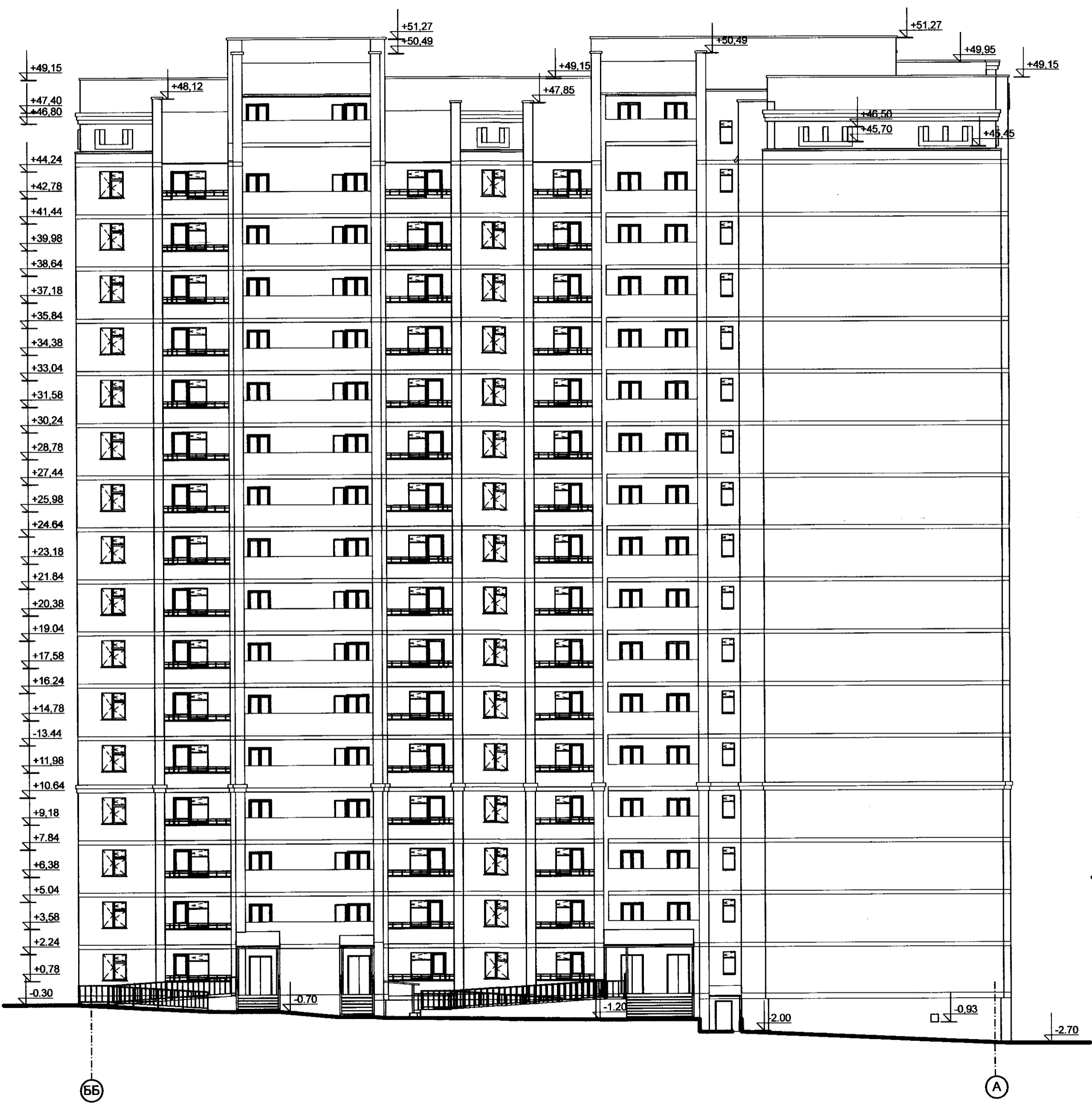
Фасад в осях ББ-А:
