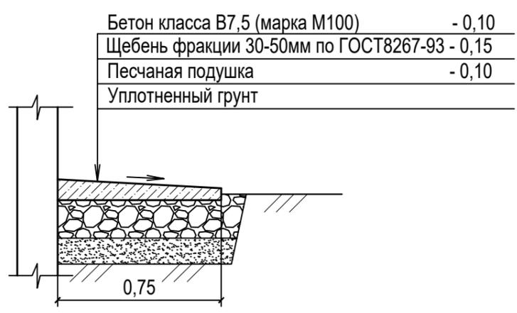
Конструкция щебеночного проезда Тип 5
