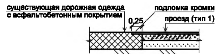
1-1 Сопряжение существующей дорожной одежды с проектируемой
