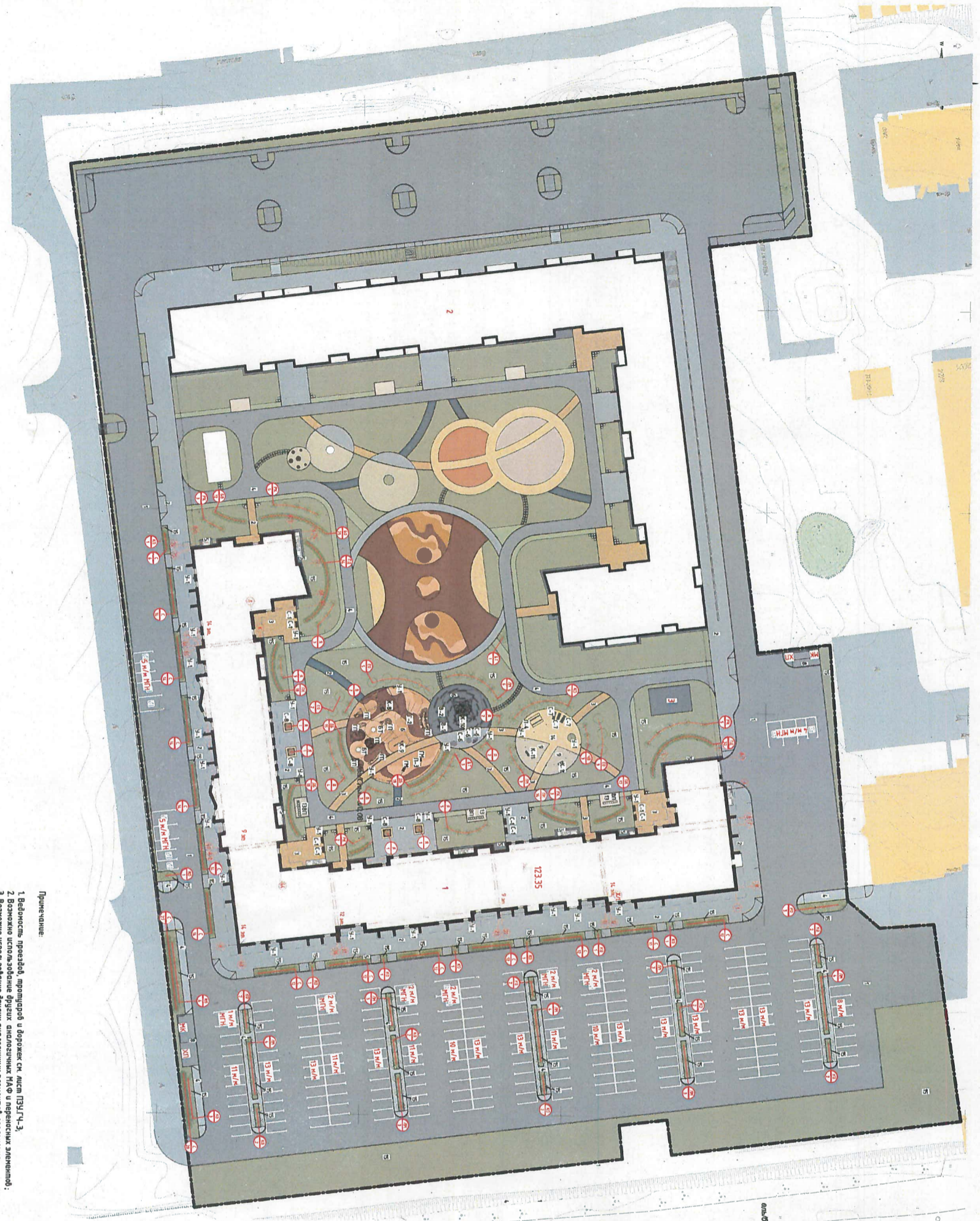
Схема планировочной организации земельного участка с решением по планировке, благоустройству и озеленению территории М:1500
