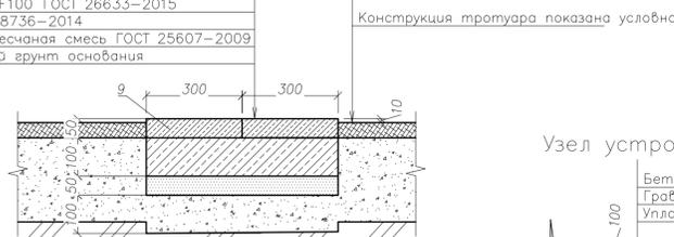
Узел устройства отмостки (Тип 9)
