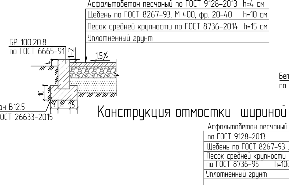
Конструкция покрытия тротуаров (тип II)
