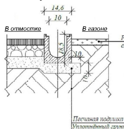
Схема устройства водоотводных лотков ЛВ1 в газоне
