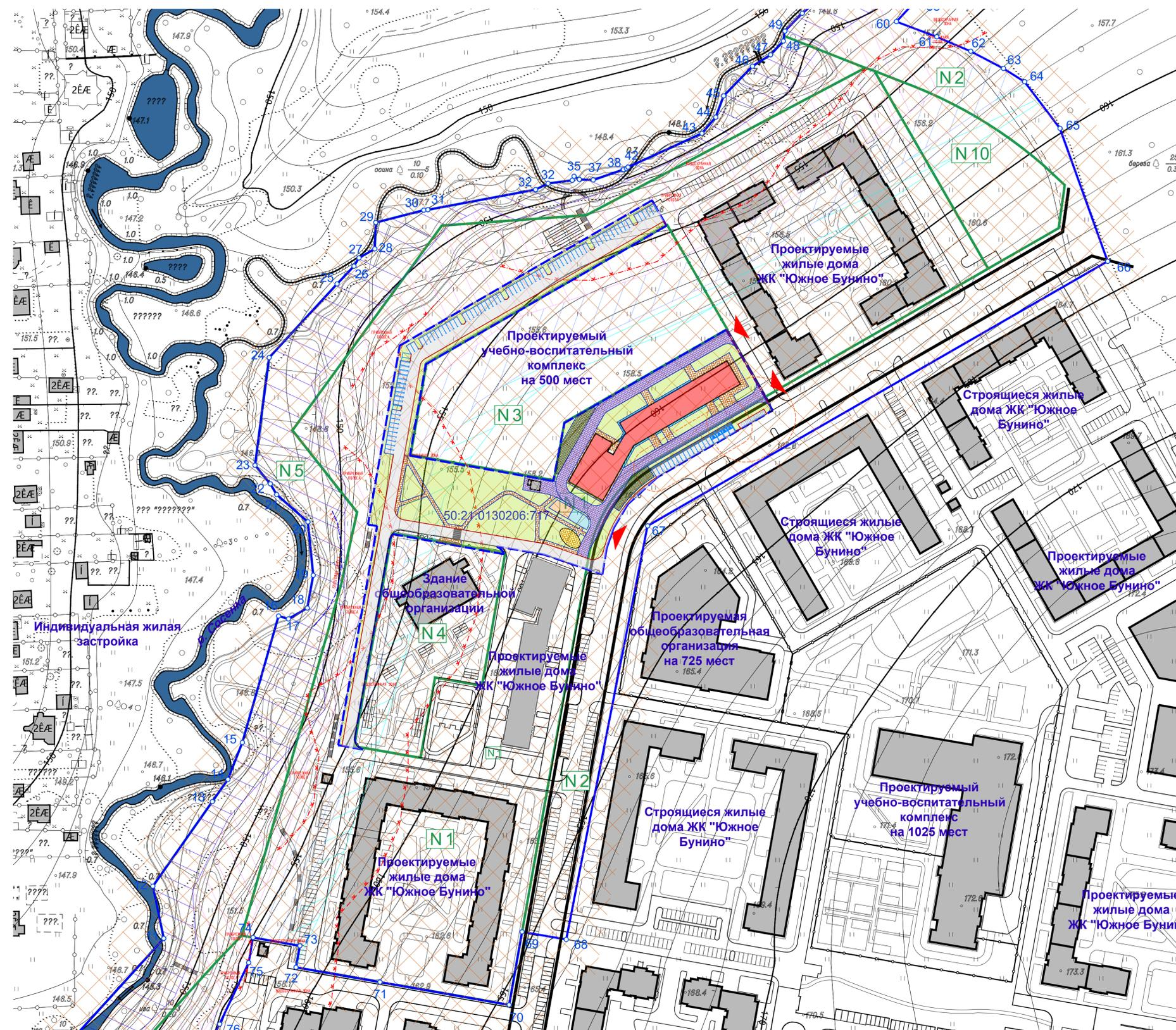
Ситуационный план разработан на чертежах градостроительного плана земельного участка в масштабе 1 : 2000 на топографической основе , выполненной ГБУ "Мосгоргеотрест" в 2021 г. Коммуникационные сети нанесены по состоянию на 06.2017 года.
