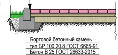
**Конструкция укрепленной поверхности для проезда пожарной техники. тип-7**
