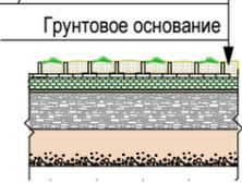
**Конструкция резинового покрытия (площадка ПД) тип-4**
