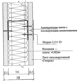
Рис. 2 Конструкция перегородки
