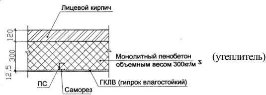
Рис.1 Конструкция наружной стены
