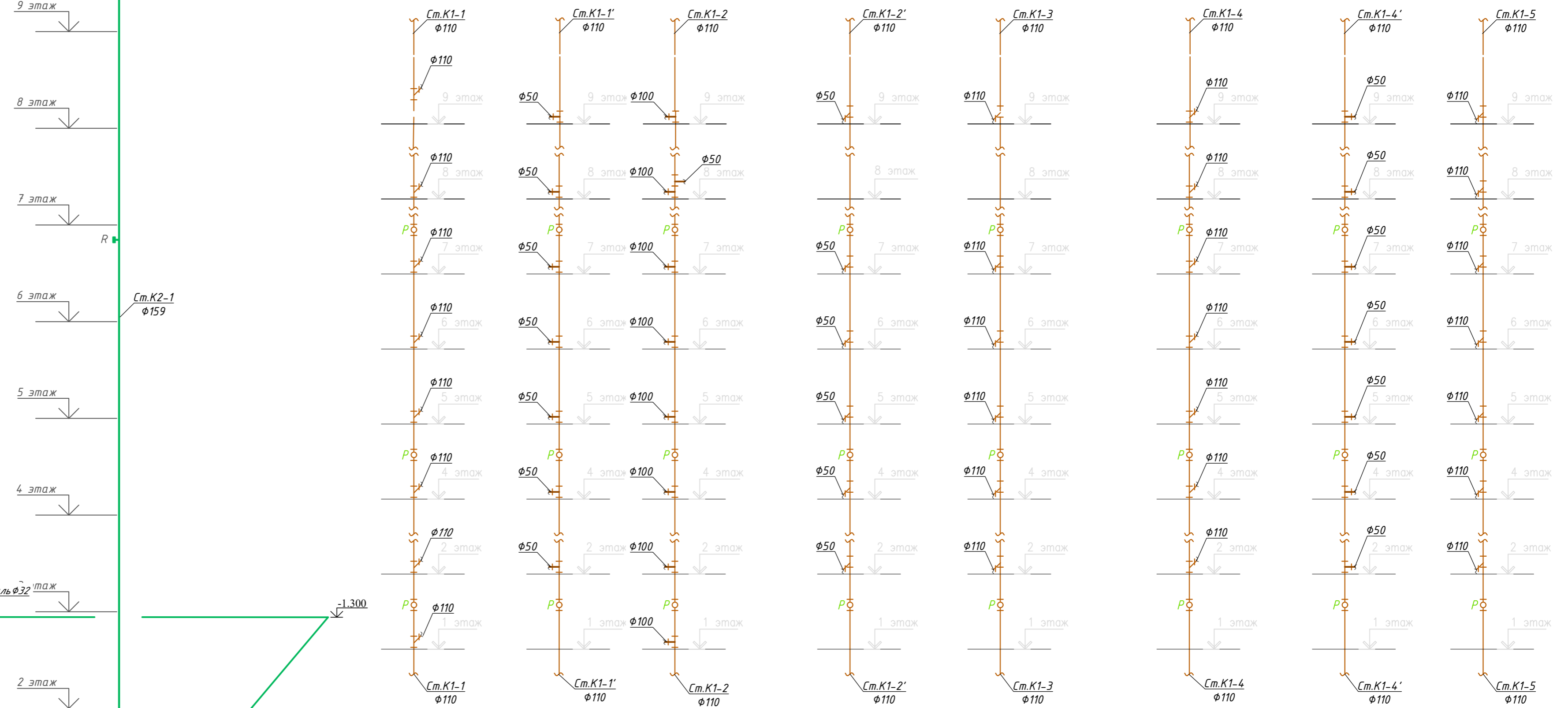
Схема системы стояков канализации жилой части здания
