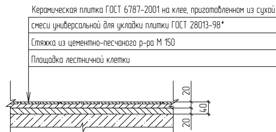
Узел 8 Типовой этаж – площадки ЛК, коридор межквартирный
