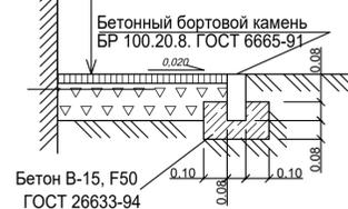
КОНСТРУКЦИЯ АСФАЛЬТОВОГО ТРОТУАРА ТИП 3
