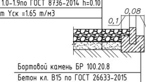
1. Поверхность крупнозернистого асфальтобетона обработать жидким битумом 0.2л/м², а поверхность щебня -0.6л/м².
