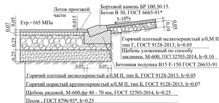
\*Примыкание тротуара к проезжей части из бортового камня БР 100.30.15 устраивается в местах пересечения тротуара с проезжей частью с учётом потребностей инвалидов и маломобильных групп населения
