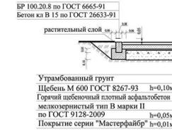
**Конструкция асфальтобетонных тротуаров**
