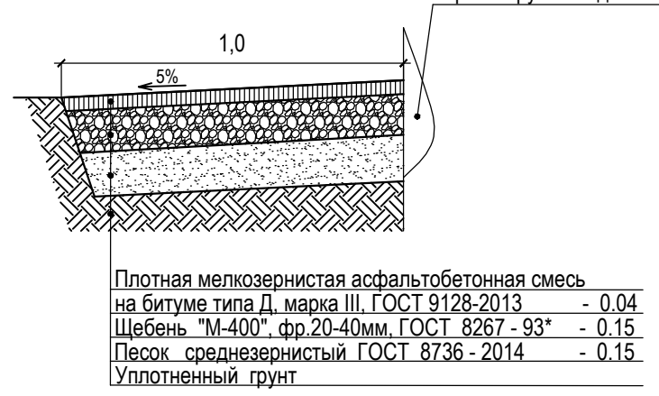
Устройство отмостки (тип 7)
