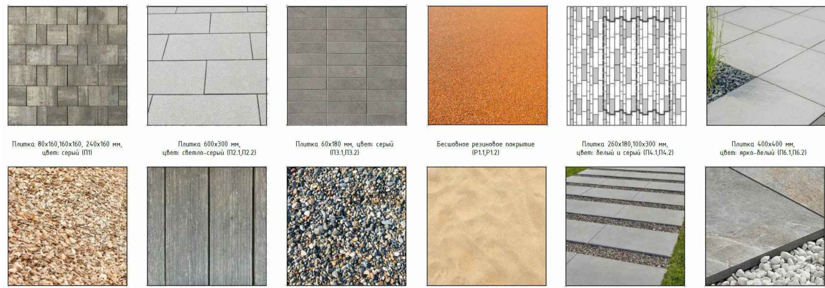
Деревянная щепка (ДЩ) Террасная доска материал: лиственница (ТД1, ТД2) Гравий фракцией 5-20 мм цвет: темно-серый (Г2) Песчаное покрытие (ПС) Пешаговая плитка «Берит» габаритами 1000x400x150 мм цвет: серый (П5, П2) Керамогранит габаритами 600x600 мм, цвет: серый (П7, П7.2)
