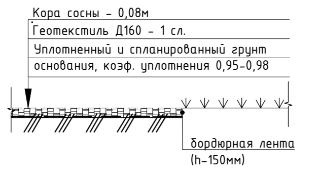
Конструкция устройства покрытия из отсыпки коры сосны (Тип 8)
