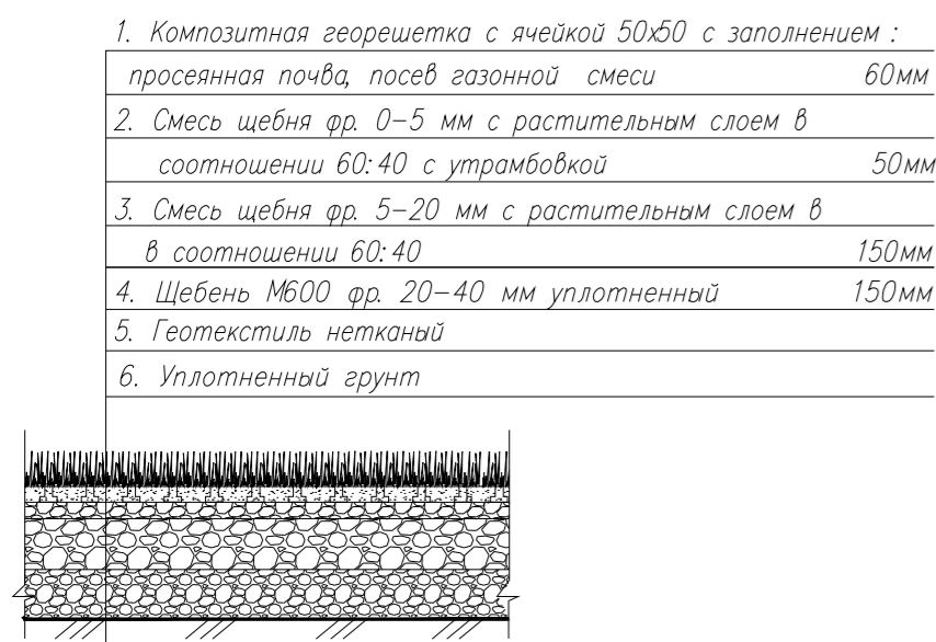
Конструкция пересечения пешеходных путей с проезжей частью для проезда МГН
