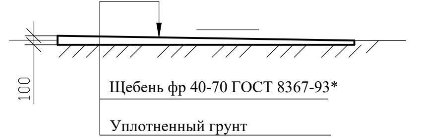
Конструкция площадки складирования
