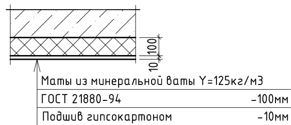
Деталь выполнения теплоизоляции перекрытия тамбуров
