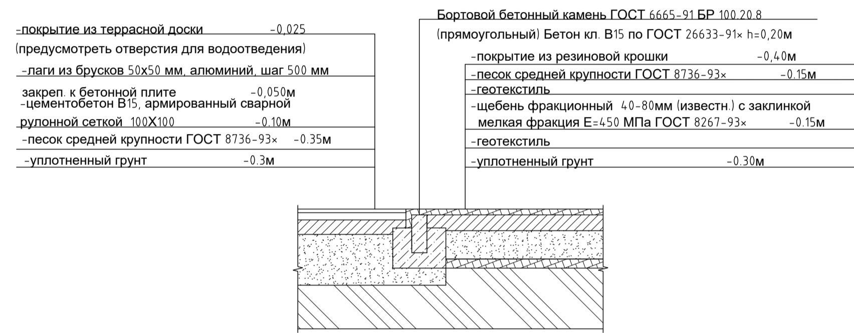
Примыкание покрытия из резиновой крошки и террасной доски. Тип 4
