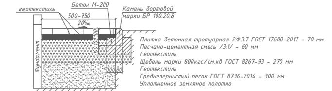
КОНСТРУКЦИЯ ТРОТУАРОВ С ПОКРЫТИЕМ ИЗ БЕТОННОЙ ПЛИТКИ (ТИП 3)
