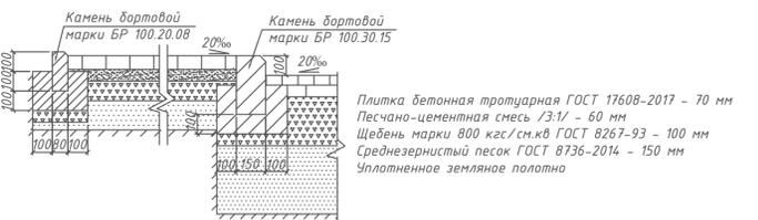
КОНСТРУКЦИЯ ТРОТУАРОВ С ПОКРЫТИЕМ ИЗ БЕТОННОЙ ПЛИТКИ (ТИП 6)
