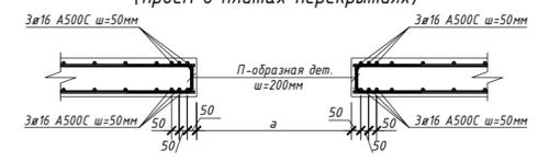
Принципиальный узел армирования торцевого участка плиты перекрытия
