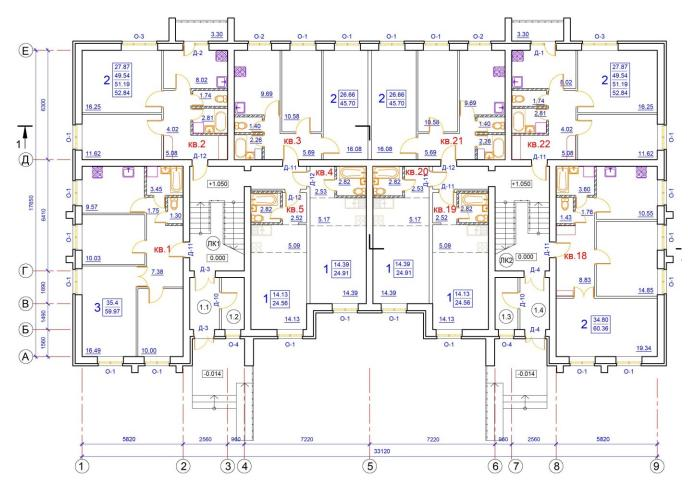
Кухонная мебель, кухонные плиты, кухонная сантехника, стиральные машины, мебель не устанавливаются. Обозначенное на плане пунктирными линиями, не возводится и не устанавливается. Местоположение сантехнических приборов в санитарных узлах указано схематично. На прилагаемом плане указанное выше нанесено условно в целях определения функционального назначения помещений.
