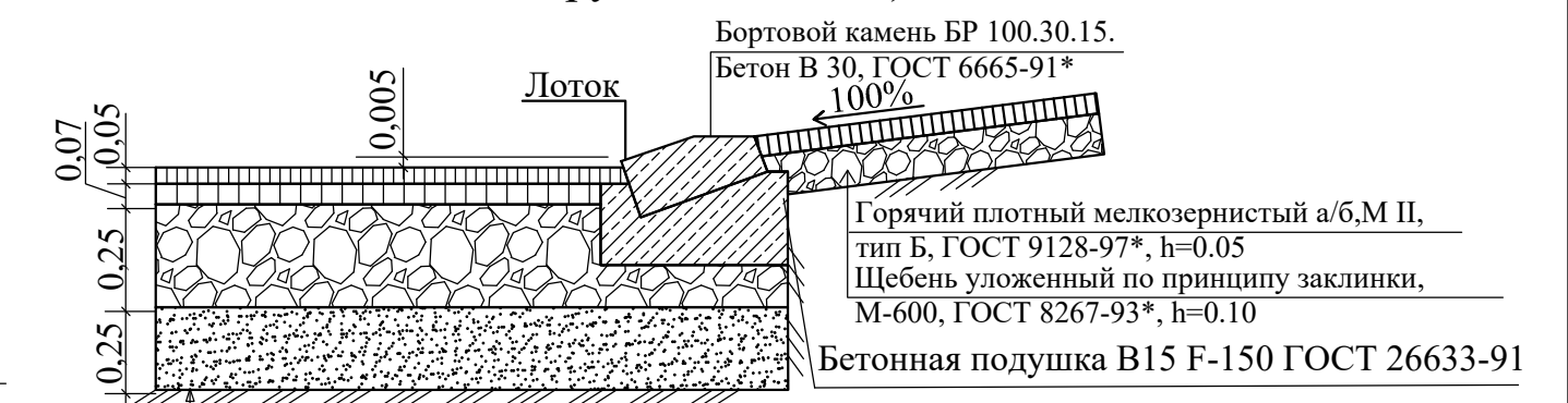
М 1:20 Конструкция покрытия детской площадки с резиновым покрытием ТИП-4
