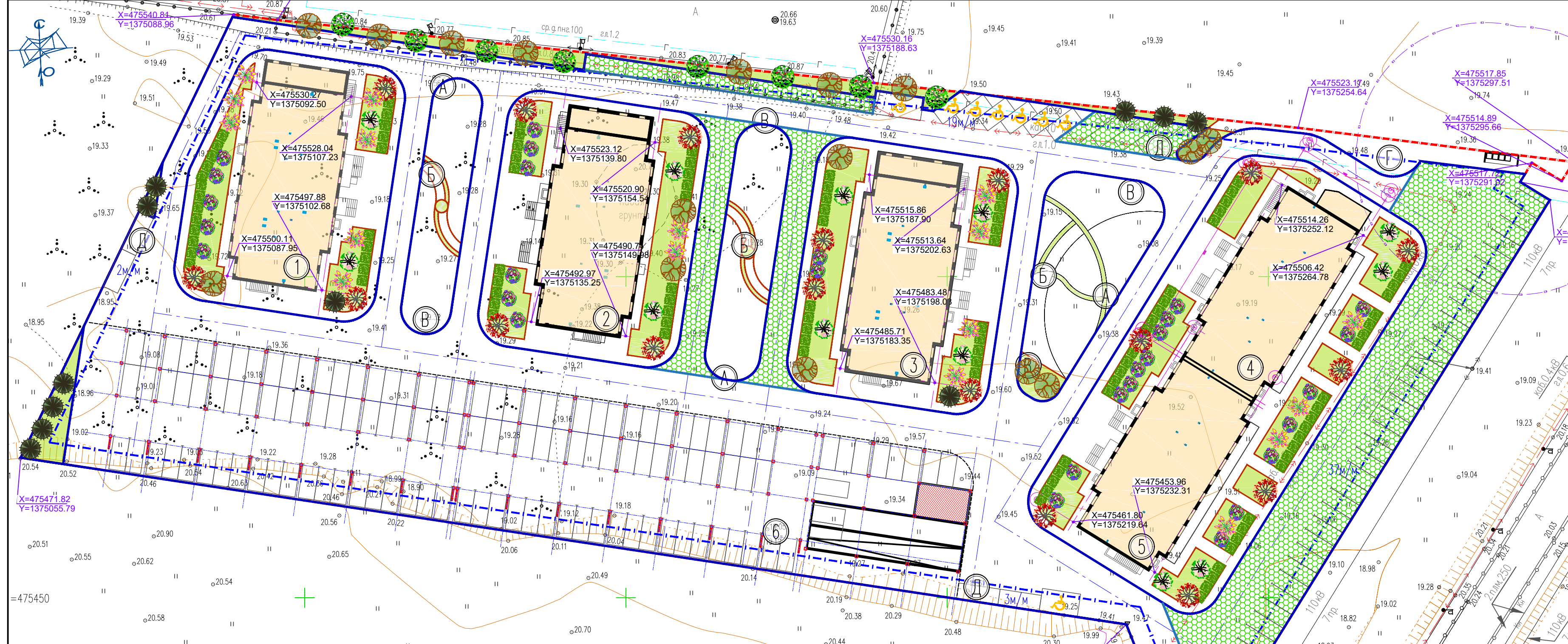
Схема расположения парковок на эксплуатируемой крыше одноуровневой наземной стоянки М 1:500
