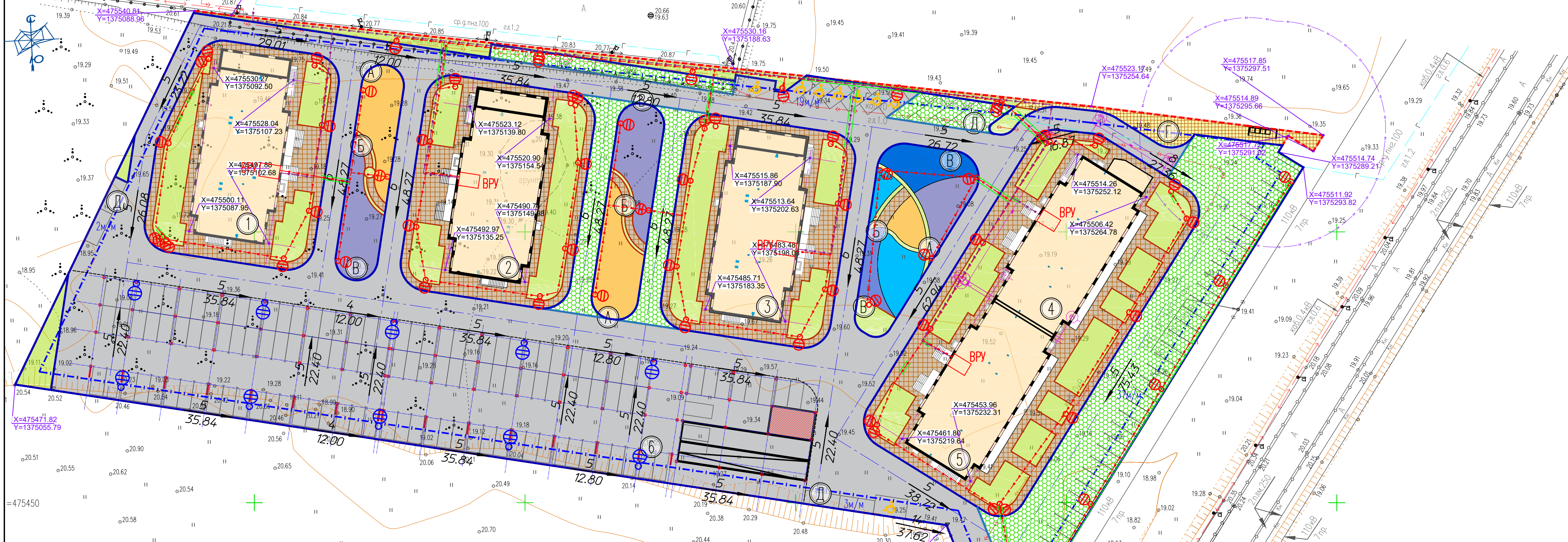
Схема расположения парковок на эксплуатируемой кровле одноуровневой наземной стоянки М 1:500
