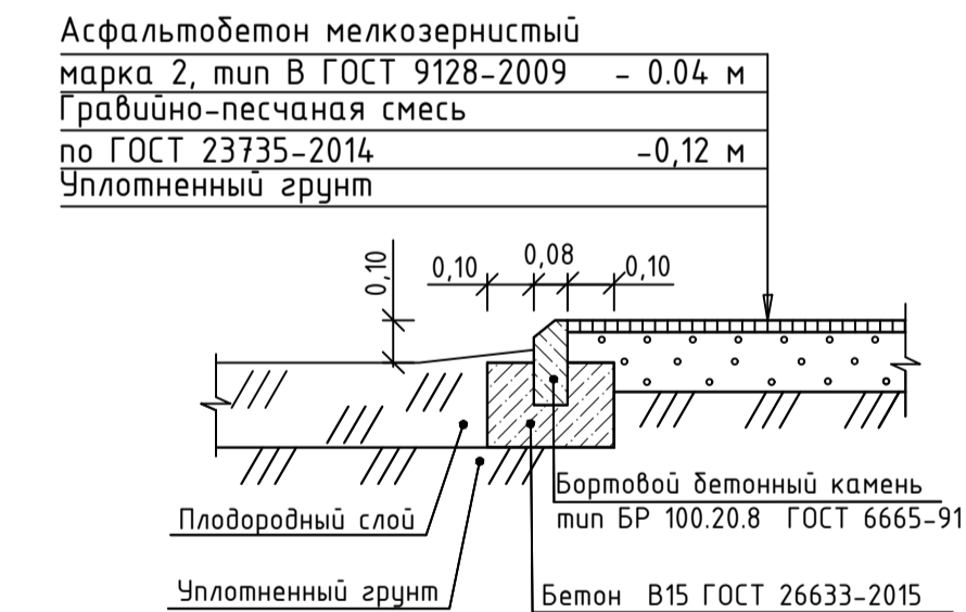
Тротуар асфальтобетонный ТИП 4 М1:20
