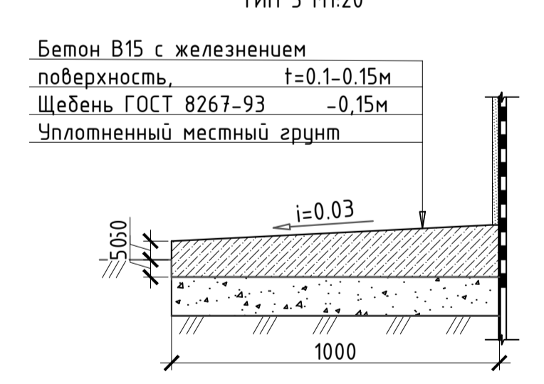
Отмостка бетонная ТИП 3 М1:20
