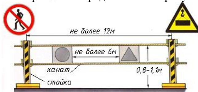
Рисунок 1 – Схемы защитного стоечного ограждения
