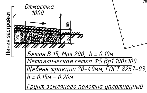
Деталь устройства бетонной отмостки (тип 2)
