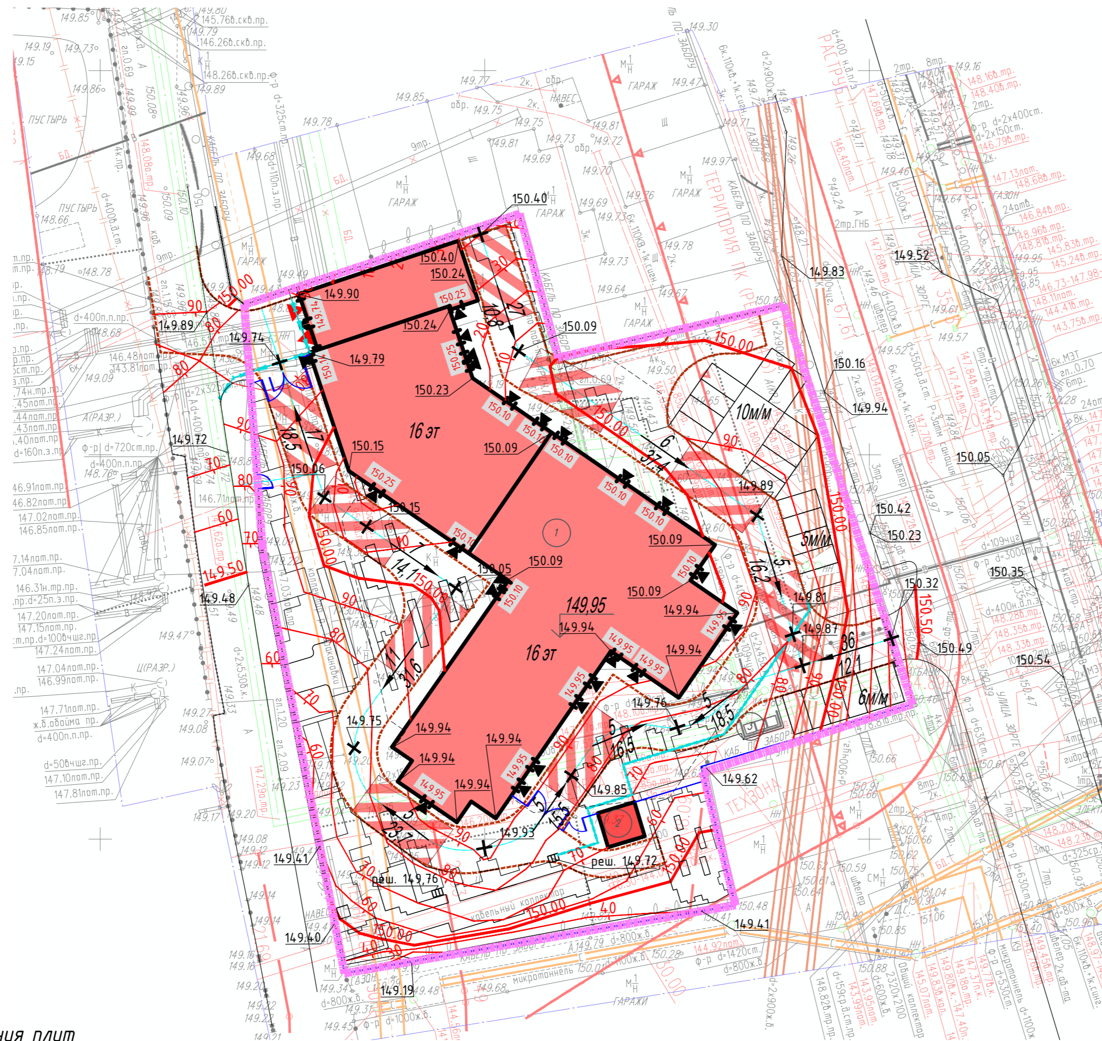
Схема расположения плит подземного паркинга М1:2000
