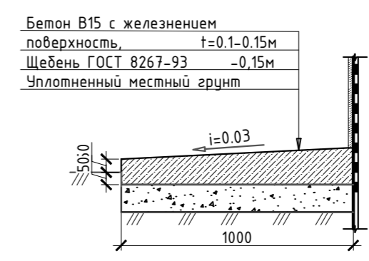
Отмостка бетонная ТИП 3 М1:20
