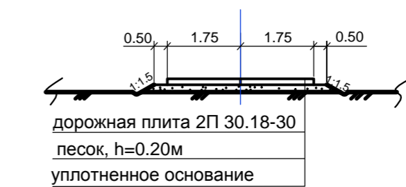
Конструкция временного проезда из плит
