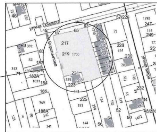
Чертеж градостроительного плана земельного участка разработан на топографической основе М 1:500 имеющейся в ИСОГД города Батайска .
