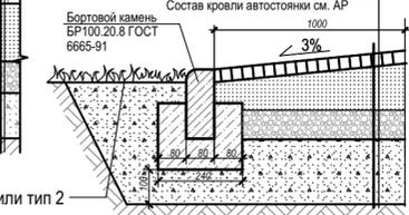
тип 7 Конструкция покрытия тротуара с георешеткой
