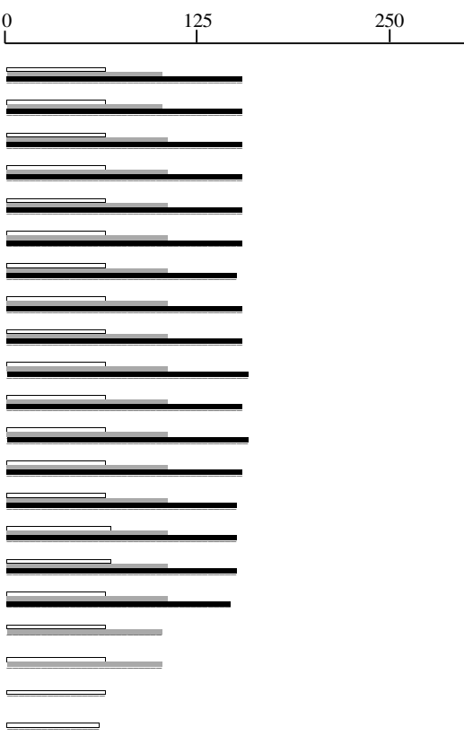
График сопротивления погружению свай, тс
