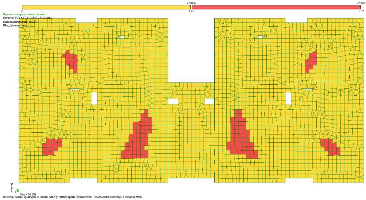
Рис. 4.69 Армирование плиты перекрытия на отм. +7.850 по оси X у нижней грани. Мозаика площади арматуры (см 2 ) на 1 метр погонный.
